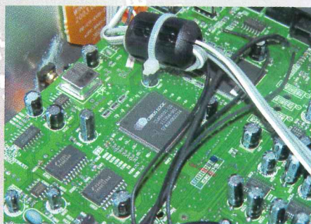
Alcuni dettagli del nuovo AVR 630: a sinistra il chip Cirrus Logic 49400, a destra una visione generale della scheda di decodifica e conversione. Sopra, invece, il layout interno, con il tunnel di ventilazione dei finali.
